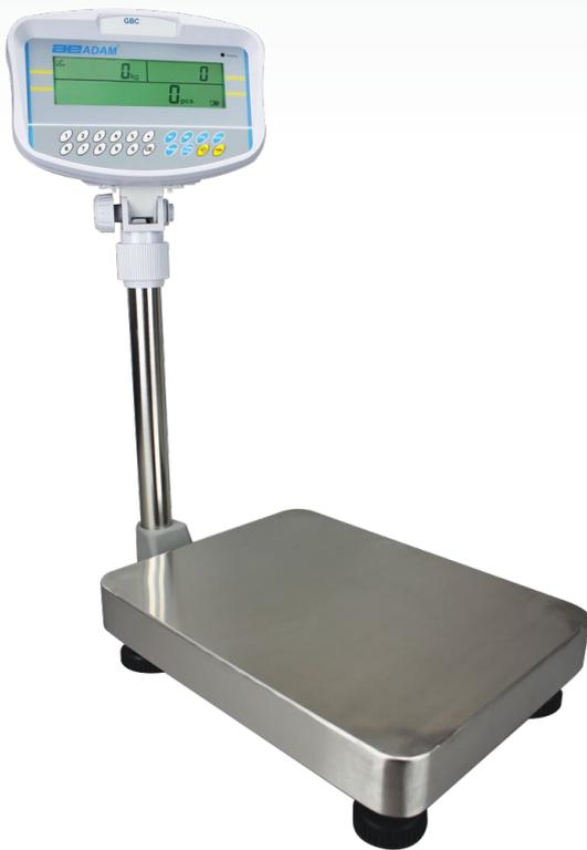
Die GBC ist eine voll funktionsfähige Zählwaage mit Ziffernblock für Einheits-Gewicht und Probe-Einträge. Das große, hell beleuchtete Display zeigt das Stückgewicht, Gesamtgewicht und die Anzahl der Teile an. Mit einer 304 gradigen Edelstahlwanne und einem auf einer Säule montierten ABS Kunststoffindikator bietet die GBC eine langlebige, zuverlässige Lösung für industrielle Aufgaben. Die Stromversorgung erfolgt durch ein Netzkabel oder den eingebauten, wiederaufladbaren Akku.
